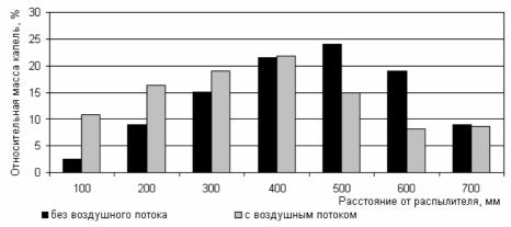
Рис. 5. Гистограмма распределения масс топлива в поперечных сечениях струи
