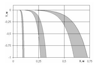
Рис. 3. Траектории капель жидкости в зависимости от их начальной скорости под углом 0° для  $v_0$  = 20±5 м/с и  $\omega$  = 0,5 м/с
