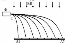
Рис. 1. Схема, поясняющая метод контроля дисперсного состава струи распыленного топлива
