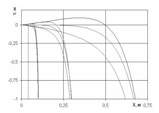
Рис. 2. Траектории капель жидкости в зависимости от их диаметра для 10, 25, 40 мкм и углов распыления -15°, 0°, 15°
