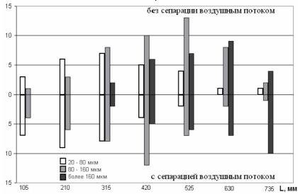
Рис. 8. Гистограммы распределения относительных масс капель, попавших на измерительное стекло на различных расстояниях от распылителя
