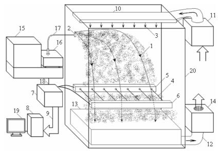
Рис. 4. Схема экспериментального комплекса «Факел-Д» контроля гистограммы топливной струи
