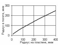
Рис. 7. Зависимость радиуса капли в полете от радиуса на измерительной пластине
